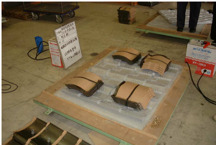
瓦を重しとして5分程載せる
