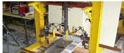
財団法人建築総合試験所の試験 1枚当たり900Nを超える接着強度を記録しました。
