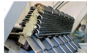
瓦屋根標準設計施工ガイドライン 棟回転試験 16段積みでも要求基準を素々クリアしました。
